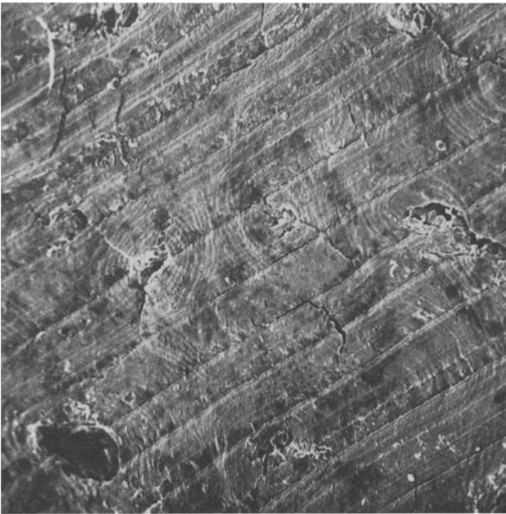
Abb. 4. Raster-EM-Aufnahme von Sägespuren am Querschnitt des verbrannten Knochens; Bildvergr.: 220 x. Der Schnitt wurde mit einer elektrischen Kreissäge (Sägeblatt 125 x 0,5 x 2,2) geführt. Wegen der Wärmeschrumpfung ist eine unmittelbare Identifikation des Werkzeuges nicht möglich. Durch Pseudomorphose sind die Osteonenlamellen z. T. an der Oberfläche erhalten.
